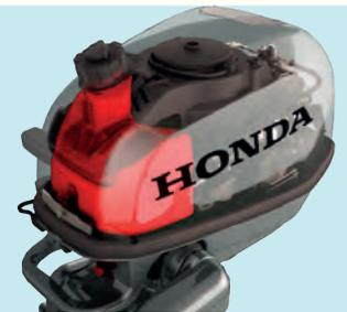
Los motores BF han sido diseñados específicamente para incorporar un depósito de combustible interno grande (1,5 L).
