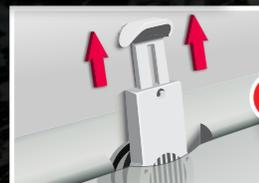
6 VÁLVULA DE DRENAJE INTERIOR DESLIZANTE
